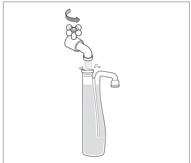
Fig. 16 Toestelsifon met water vullen
